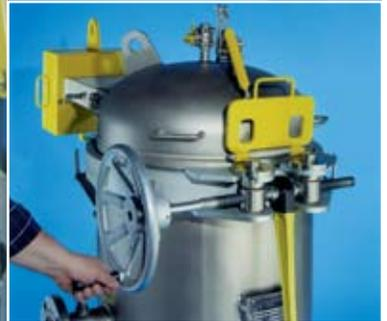
**HANDWHEEL OPERATION OF TURNBUCKLE MECHANISM**
